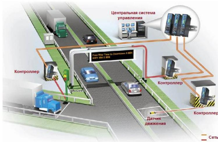
Система «Умный светофор» в этой системе предназначена для повышения пропускной способности перекрестков с помощью динамического управления сигналами светофора. Система состоит из контроллеров, камер и удаленных датчиков движения, которые в режиме реального времени оценивают загруженность перекрестков и передают эту информацию на центральный сервер управления. Связь с центральным сервером может осуществляться через радиосреду или по оптическим линиям связи.
