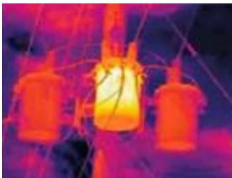
*Рис.2. Тепловизионная диагностика выделения избыточного тепла в трансформаторе.*
